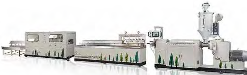
Рисунок 4 – Комплектация производственной линии по производству ДПК
